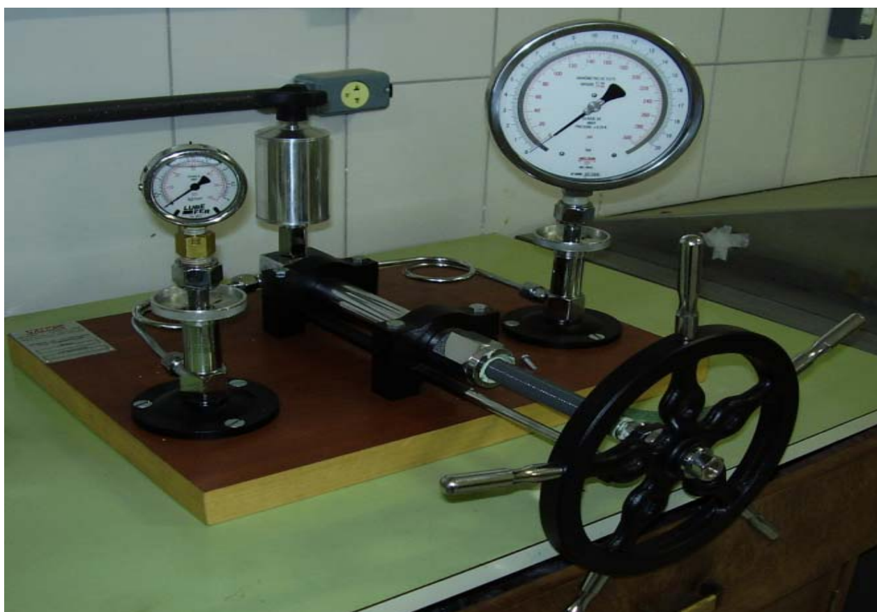
Figura 1. Bancada do manômetro do tipo padrão e o manômetro teste .
